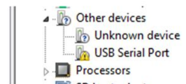
عدم نصب کامل مبدل
