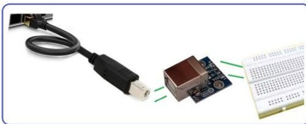
شکل 1: راه اندازی برد تبدیل ABn221AB
