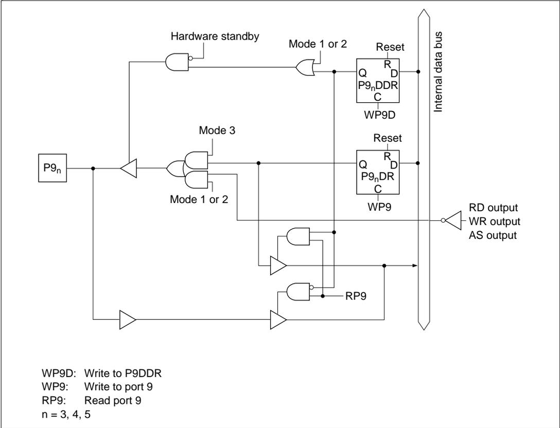
**Figure C.9 (d) Port 9 Block Diagram (Pins P9<sub>3</sub>, P9<sub>4</sub>, P9<sub>5</sub>)**
