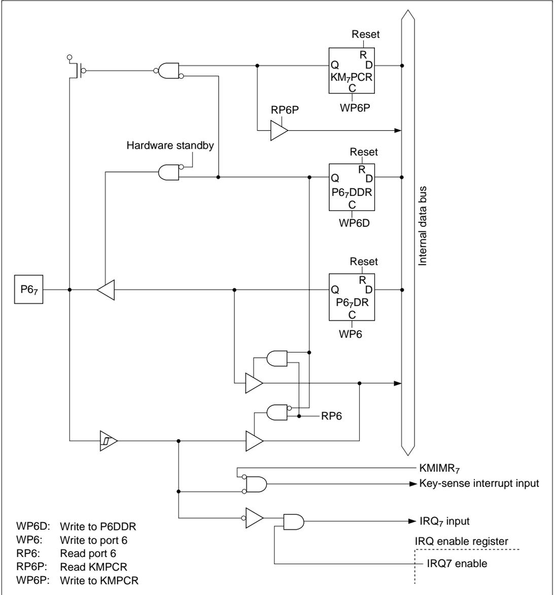
**Figure C.6 (d) Port 6 Block Diagram (Pin P67)**
