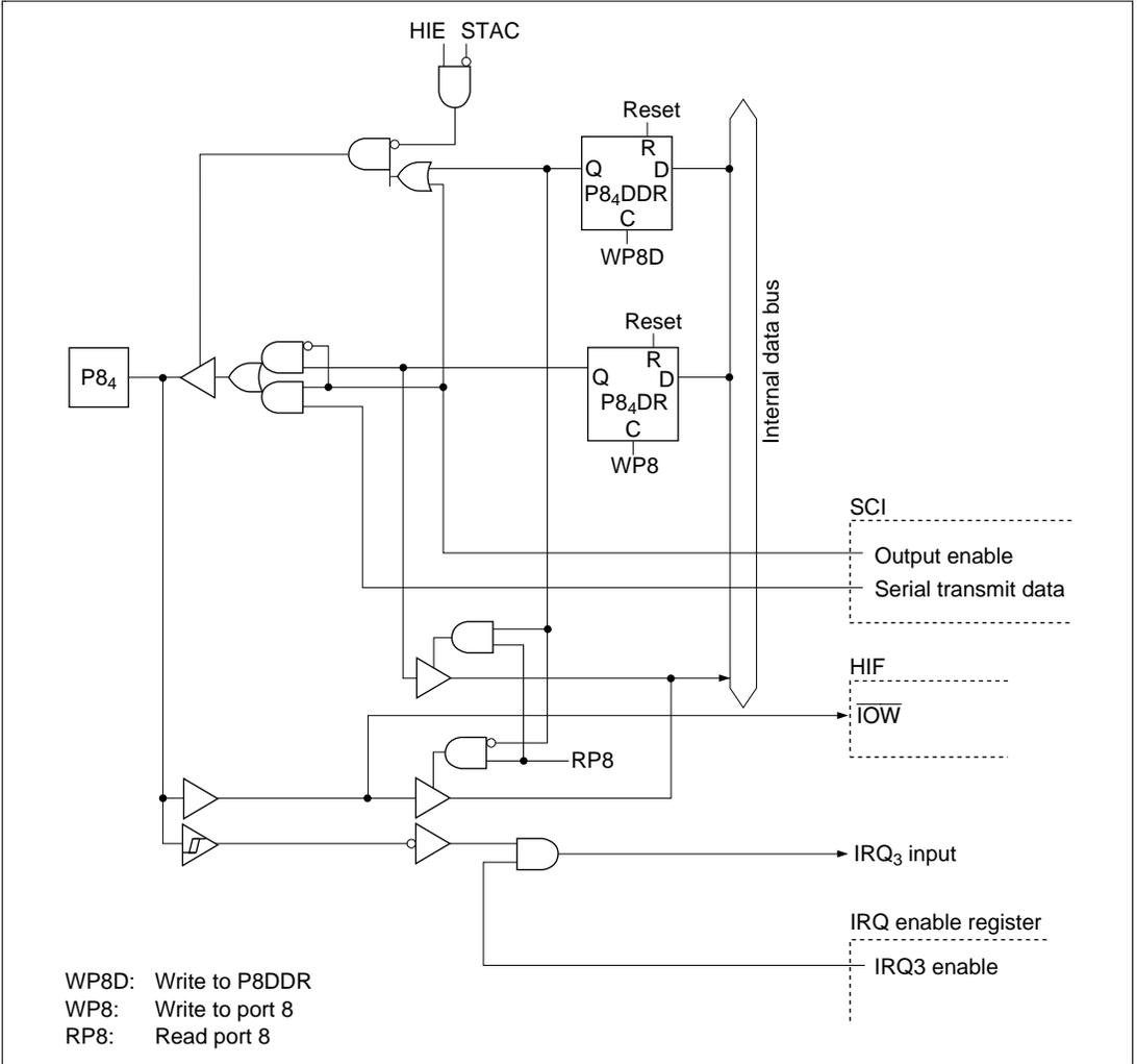
**Figure C.8 (d) Port 8 Block Diagram (Pin P8<sub>4</sub>)**
