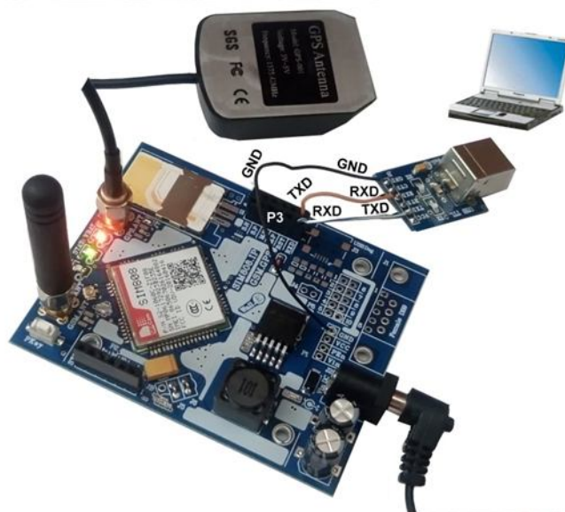
شکل 2: اتصال برد توسعه ABg184N-C به رایانه توسط مبدل یو اس بی
