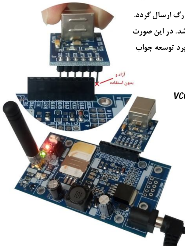
شکل 2: اتصال برد توسعه ABg114P-C به رایانه توسط مبدل یو اس بی
