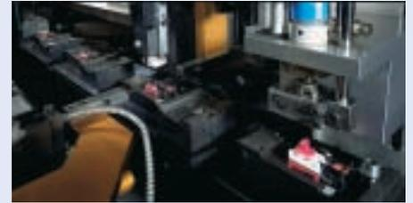
Fiabilité élevée des horloges programmables grâce à la fabrication entièrement automatique des moteurs synchrones.
