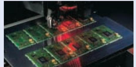
Mise en place des composants sur carte électronique par la technologie SMD.
