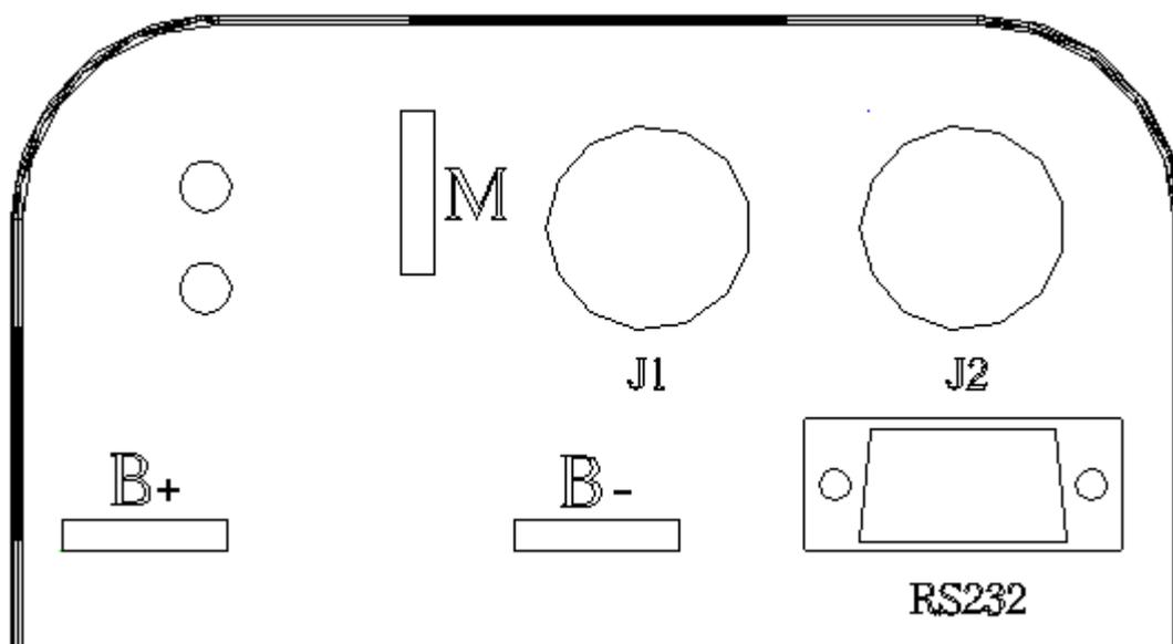
图 2: KDHA 电机控制器前面板
