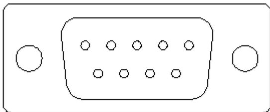
图 8 是一个标准的 RS232 接口，可与计算机连接并使用配置软件对控制器进行配置和标定。请使用标准 DB9 串口延长线连接控制器至电脑（非交叉延长线）。
